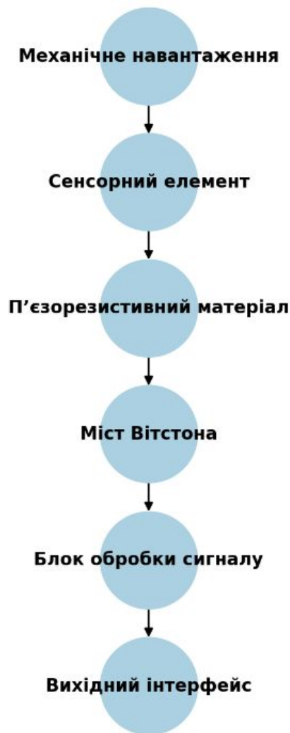
Рис. 1.3. Блок-схема структури п'єзорезистивного МЕМС-сенсора для вимірювання механічних навантажень
