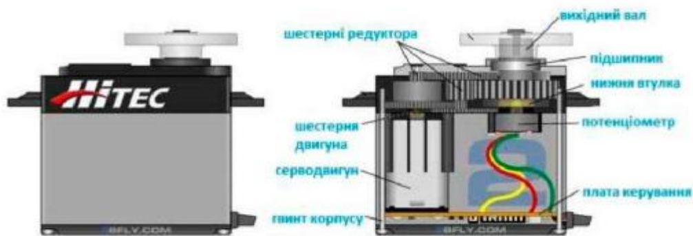
Рис. 4.12 - Будова серводвигуна
